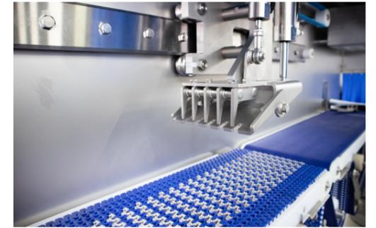
Mientras la garra garantiza que los cortes no se muevan hacia atrás, el soporte superior evita que las piezas se muevan hacia los lados en la sección de alimentación. La combinación entre garra y soporte superior garantizará cortes precisos con un peso predeterminado y una alta calidad de corte, listos para ser envasados y presentados en los puntos de venta.
