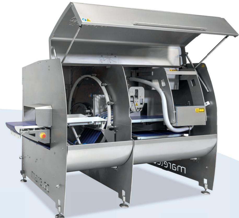
Der PORTIO 3 ergänzt den PORTIO 1 um zwei seitliche Kameras. Dadurch kann die Maschine die Abtastung verbessern und tote Winkel an der Seite des Produkts abdecken, die von der oberen Kamera allein nicht erkannt werden können. Er wird zum genauen Portionieren von rotem Fleisch, ganzem Fisch oder anderen Produkten mit unregelmäßiger Form in vertikaler Richtung verwendet. Die Maschine kann mit den auf Seite 20 genannten Optionen ausgestattet werden.
