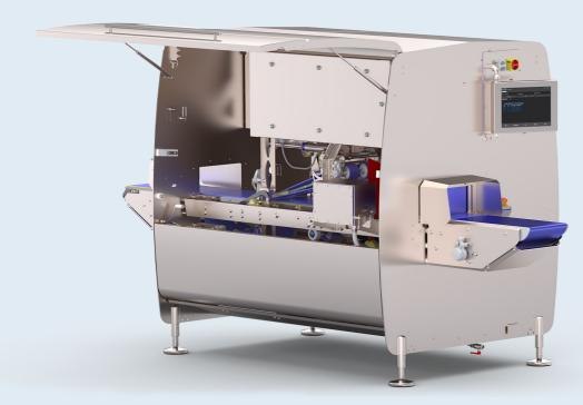
Der PORTIO Plus kann neben der oberen Kamera mit 2 seitlichen Kameras für rundere Produkte ausgestattet werden und kann den Winkel des Messers gegenüber der vertikalen Position von 0° auf 30° oder 45° ändern. Das angewinkelte Schneiden verleiht den geschnittenen Portionen ein natürlicheres Aussehen und sorgt für eine größere Abdeckung des Tellers.
