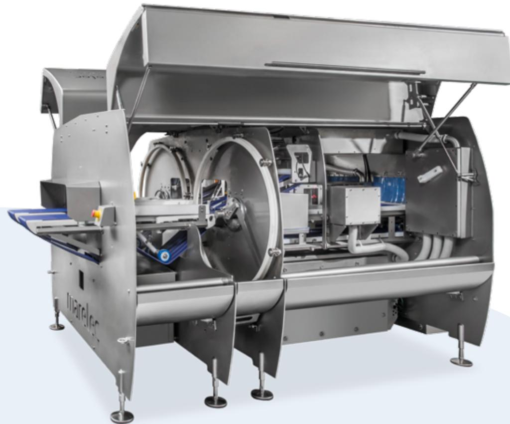
PORTIO 3D 是一款双通道机器，旨在满足肉类加工行业对高产能的需求，配备 300 毫米或者350毫米传送带和侧面相机，可实现最大扫描精度。两条通道集成在一台机器中，但彼此完全独立运行，每个通道都有自己的控制面板。与其他典型的肉类机器一样，它具有单独的进料传送带，以减少放置较重的一块肉同时仍扫描前一块肉的影响。可在第 20 页上看到通常为肉类加工而设计的各种附加选项。
