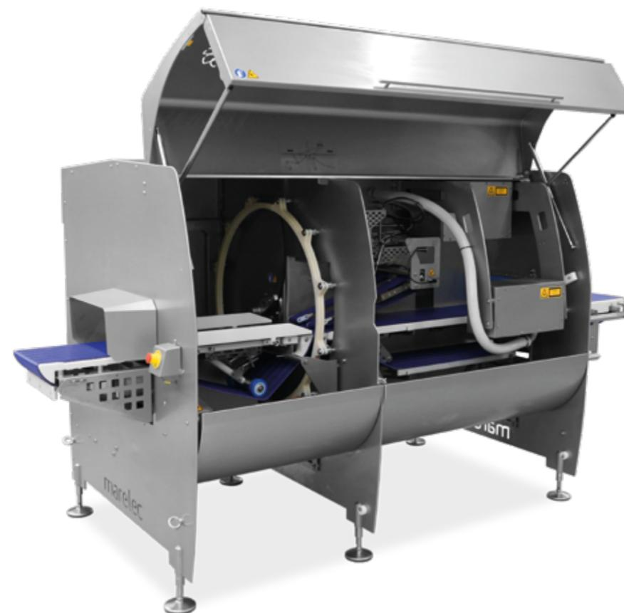
对于宽度超过 240 毫米的大块肉，MARELEC 在其产品系列中增加了三种更宽的 PORTIO 型号，皮带宽度可能为 350 毫米或 400 毫米。这些 PORTIO 都配备了三个摄像头，性能强大，可以轻松进行垂直切割。进料由两个独立的进料输送机组成，以减少放置较重肉块的影响，同时仍扫描前一块肉，同时皮带支撑更加坚固。400 毫米版本配有伺服电机，功率是前者的两倍，可以驱动刀具切开最坚硬的肉块
