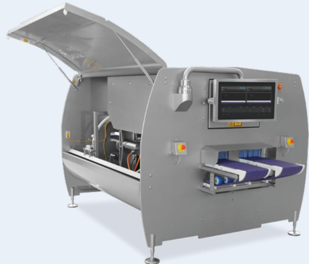
为了实现家禽和小鱼片的最高产能，MARELEC 开发了一种带 229 毫米皮带的双通道 PORTIO，能够加工宽度高达 210 毫米的产品。两条通道集成在一台机器中，但彼此完全独立运行，每个通道都有自己的控制面板。切割速度标准增加到每秒 25 次切割。两条通道都可以在五个位置（0/15/30/45/50°）独立调整切割角度，并且都具有获得专利的自动调整进出料皮带。全不锈钢伺服电机驱动刀具，使 PORTIO 1DAP 成为市场上最卫生的型号。两条通道都可以通过一个触摸屏界面单独操作，该操作界面可以旋转到最符合操作员人体工程学的位置。
